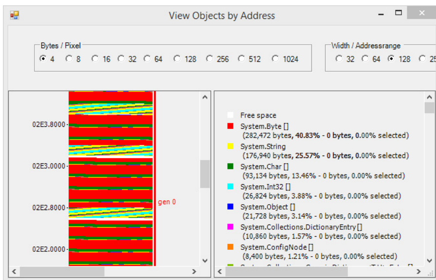
图 2-12 CLR Profiler 可以把内存堆的情况图形化展示出来，这样就能发现空闲内存块旁边存放的是什么类型的对象。本图中空闲内存块被 System.Byte[] 和各种其他类型包围着
